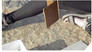
Depositar a chapa na tina de ácido atentando no tempo de acidulação, utilizando um relógio ou o cronómetro do telemóvel.
