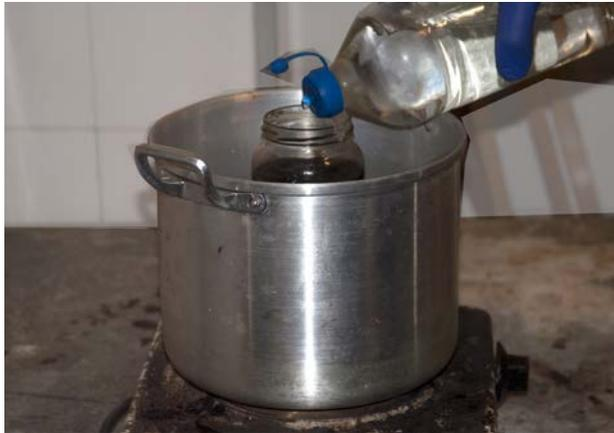
Porque a benzina evapora facilmente, colocar a tampa sobre o frasco, deixando no entanto uma pequena abertura, permitindo o calor dissipar de um modo controlado. Deixar a mistura durante 6-7 horas em lume médio.
