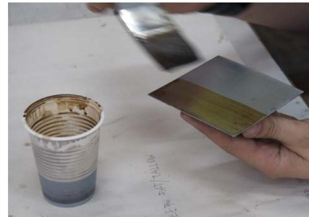
Aplicar uma camada de verniz duro sobre a camada de gordura com uma trincha de pêlo sintético.
