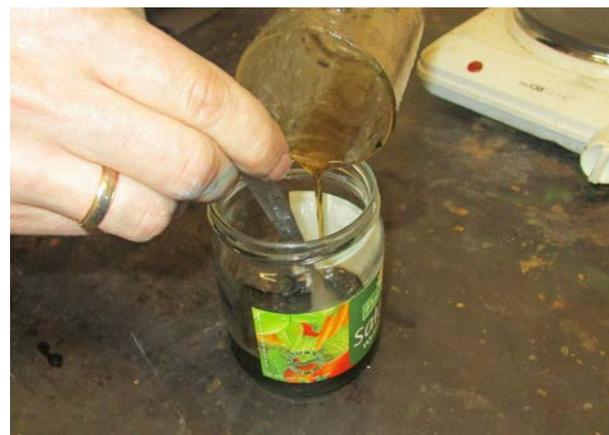
Assim que derretida, verter a gordura para dentro do frasco preparado no dia anterior com verniz duro diluído.
