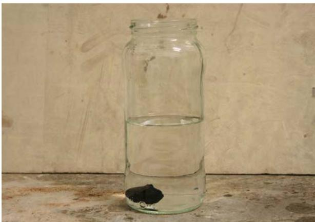
Colocar o pedaço de asfalto num frasco de vidro.
