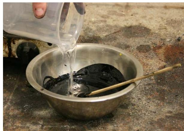
Colocar o recipiente fora da ação do calor e após deixar arrefecer, verter a essência de terebentina e mexer a mistura com a vareta.
